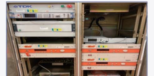
MIL RS103 40 GHz 시험 시스템
