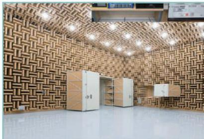
음향 챔버 및 소음진동 측정시스템
